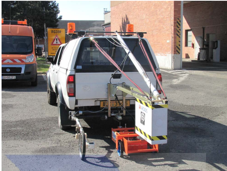
Obr.3 Ukázka měřícího vozu pro měření tloušťek konstrukčních vrstev vozovky s dvoukanálovou aparaturou, anténní systémy 400 MHz a 1 GHz typu „HORN“.
